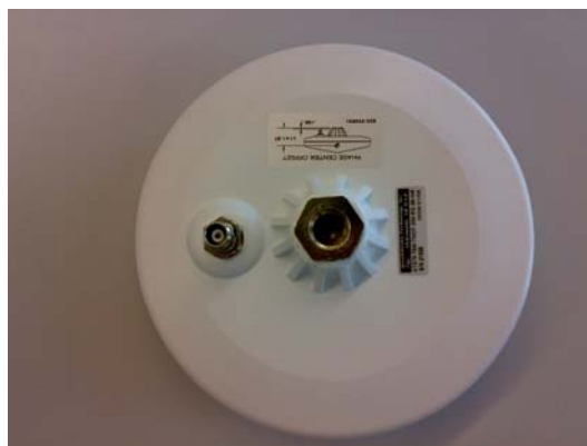
Figura 3.26 Antena GPS (visión posterior, conector y anclaje)
