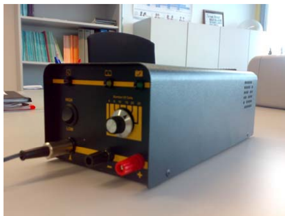
Figura 3.42 Cargador de baterías Ni-Cd de 20 células
