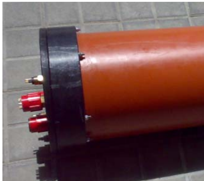
Figura 4.18 Tapa de conectores herméticos encajada en el tubo estanco
