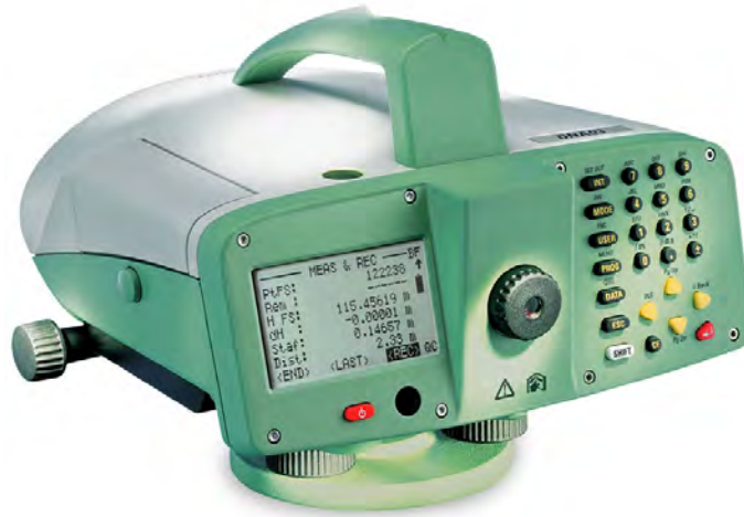
Figura 3.5: Nivell automàtic adequat per anivellacions d'alta precisió.
