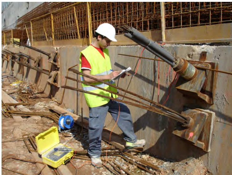
Figura 4.9. Ús d'una unitat de lectura en una cèl·lula de càrrega
