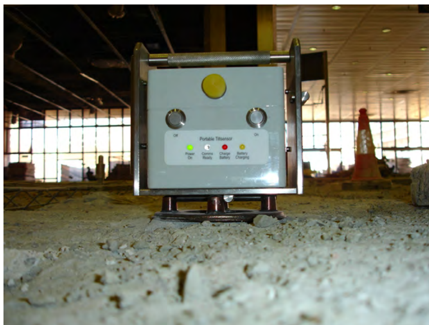
Figura 4.3. Lector de clinòmetre situat damunt de la seva base.
