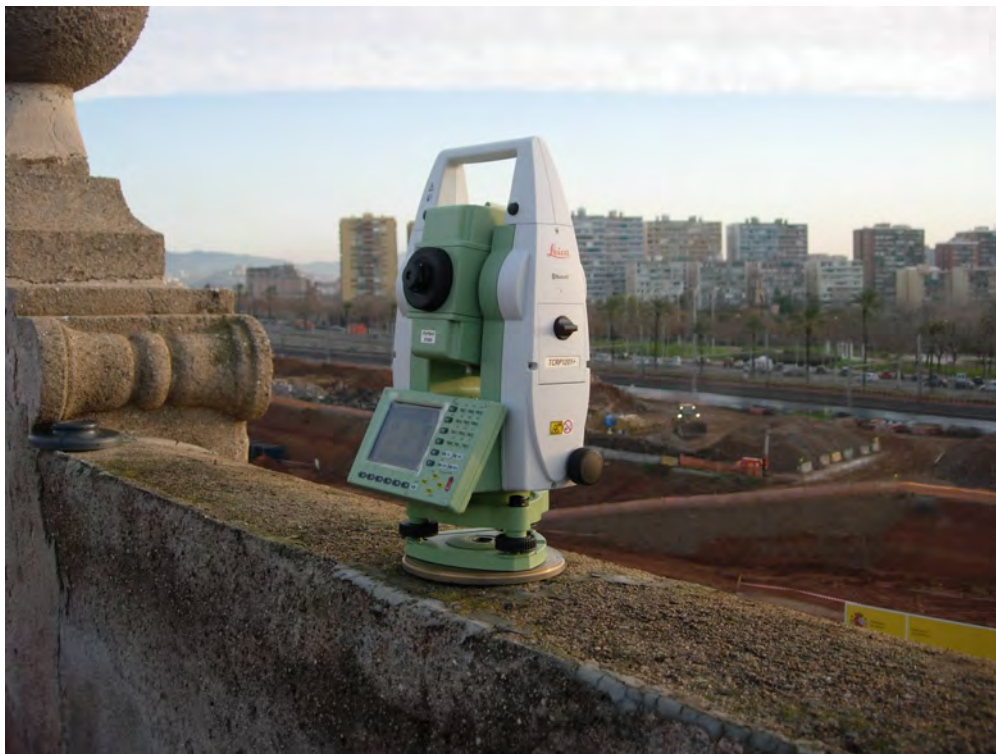
Figura 3.14. Estació total situada en una base de centrat forçat.
