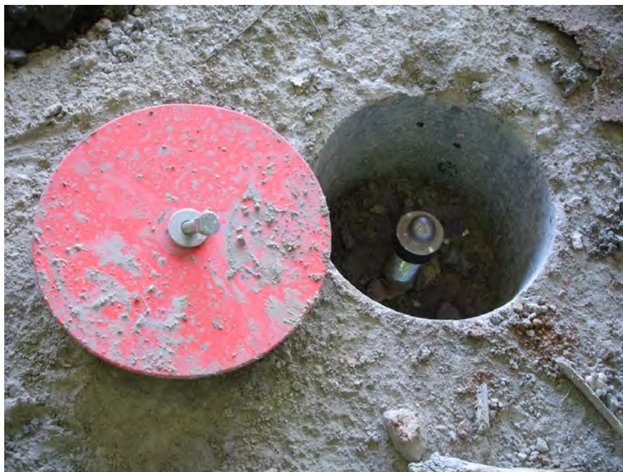
Figura 3.4: Fita d'anivellació superficial i la seva corresponent protecció.
