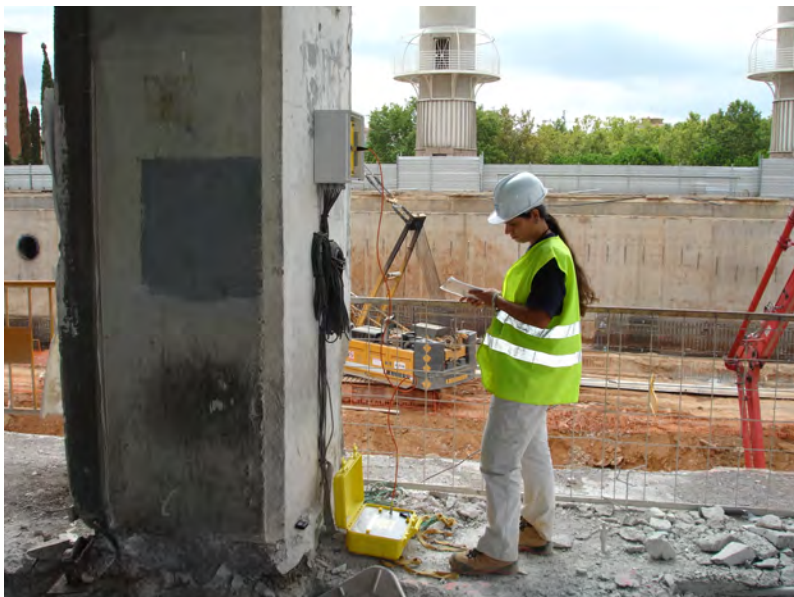
Figura 4.5. Presa de dades d'extensímetres mitjançant una unitat de lectura portàtil.
