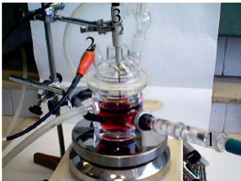
Figura 3.3. Celda electroquímica utilizada junto con los tres electrodos: (1) Electrodo de referencia, (2) electrodo auxiliar y (3) electrodo de trabajo.
