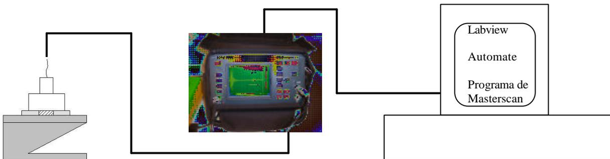
Fig. 12: Esquema del sistema de medidas de ultrasonidos
