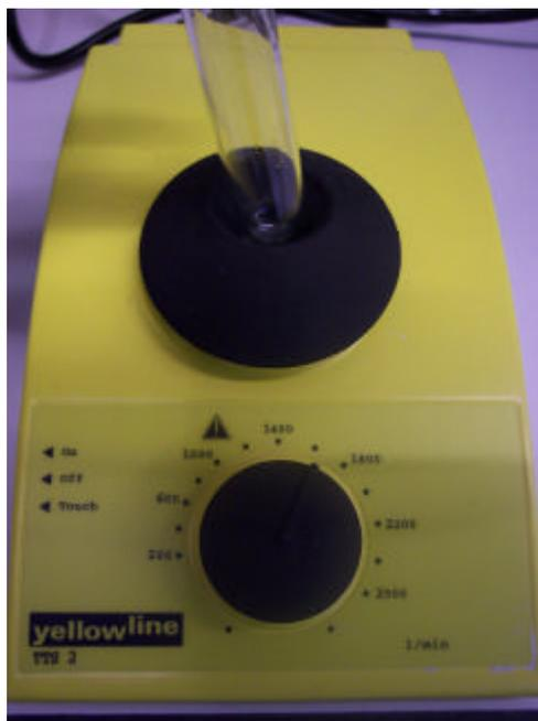
*Fig. 13: El aparato vibrador para mezclar el cemento*
