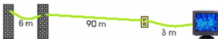
**Fig. 5.2.** Longitudes máximas del cableado horizontal
