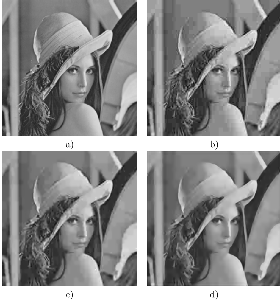
Figura 5.2: Codificació/descodificació de la imatge Lena de 256x256 píxels a molt baixa qualitat: a) original, b) JPEG qualitat 10 - PSNR 26,04 dB, c) descodificació amb Froment [2] (pesos de Froment, 12 iteracions, mida inicial de pas 1) - PSNR 28,92 dB, i d) descodificació amb Froment (com abans) seguit de Trianta [28] ( \sigma_{lf} = 2, \sigma_{hf} = 2,5, \sigma_{WSMM} = 1, \mu = 5, T = 500 ) i projecció sobre QCS - PSNR 27,90 dB
