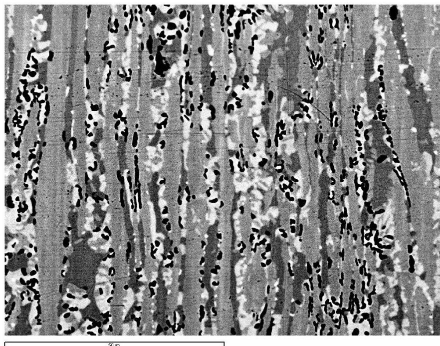
Figura 39. Micrografia de SEM observada mitjançant SE corresponent a l'acer RL(925) després de l'assaig per determinar el E_p .
