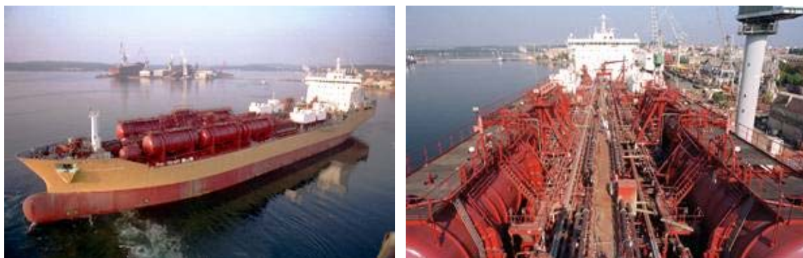
Figura 11. Tancs d'acer inoxidable dúplex per a transport marí (E.N 1.4462).
