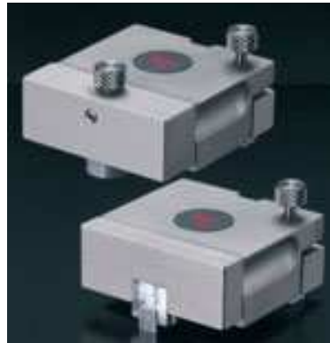
Fig.3.12. Tripods de pulido de secciones planas y de secciones transversales
