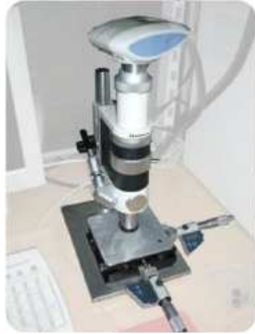
Fig. 3.17. y 3.18. Lupa utilizada y imagen obtenida de la huella de una raya con indentador Vickers
