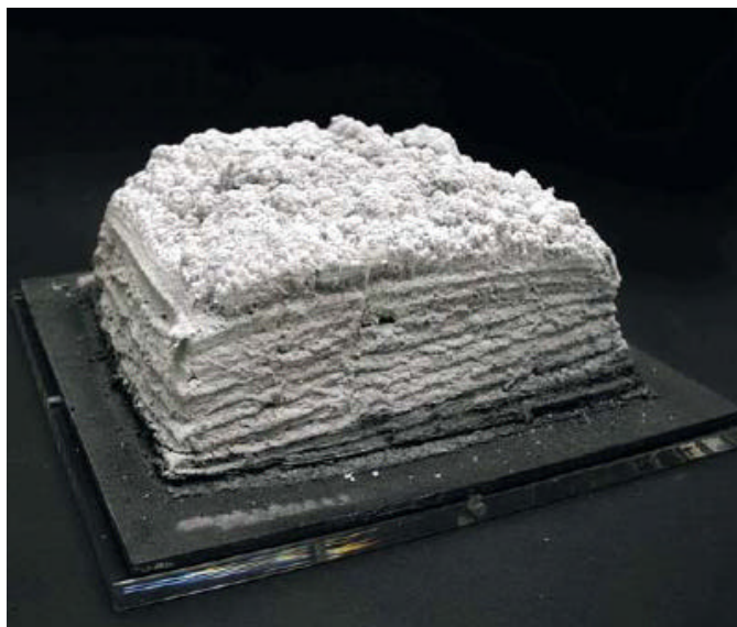
Fig. 1.1. Escuma d'una pintura intumescent després d'una prova de foc.
