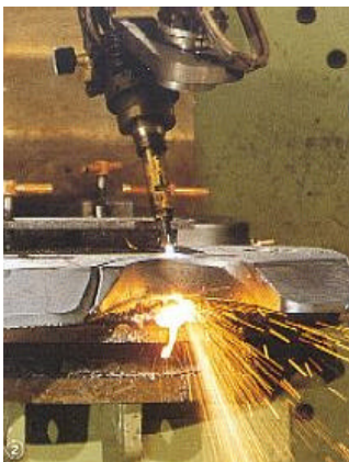
Fig.1.3. Creació d'un xamfrà amb la tècnica d'oxitall (esquerra) i taula de tall per plasma marca BBS (dreta).
