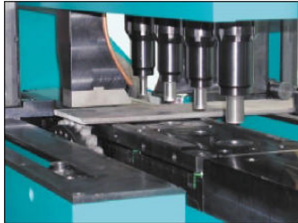
Fig.1.4. Detall de punxonadora amb quatre eixos.
