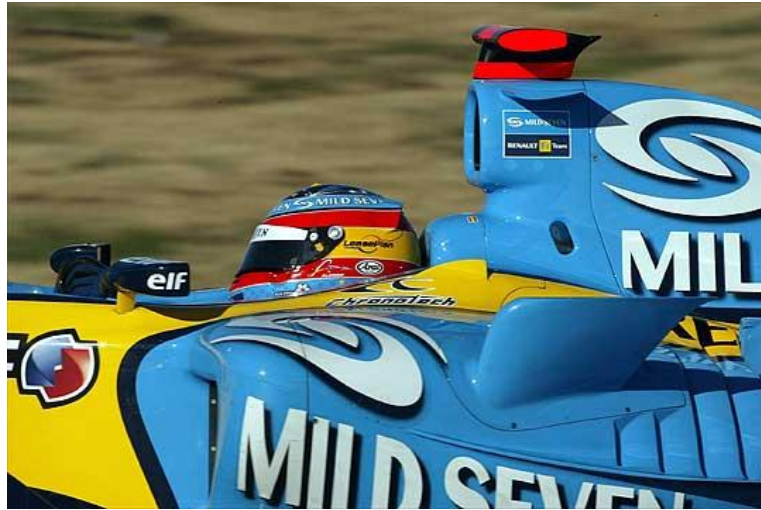
Fig. 2.8 A la part inferior dreta de la imatge es poden veure les reixes de refrigeració
