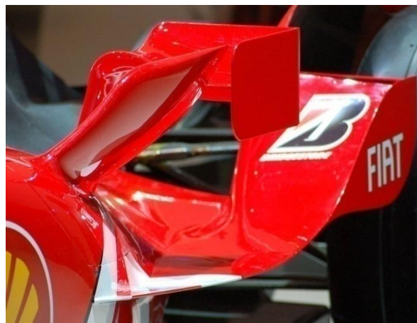
Fig. 2.9 Aletes posteriors del Ferrari F2004
