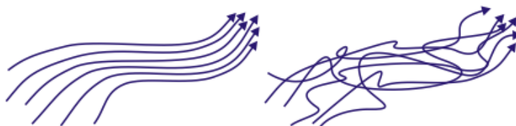
Fig. 1.10 Representació de línies de corrent. A l'esquerra línies estacionàries d'un flux laminar i a la dreta trajectòria no estacionària d'un flux turbulent
