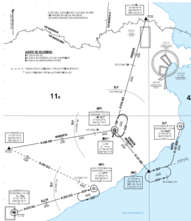
Figura 3.26: Procedimientos de llegada del aeropuerto de Girona
