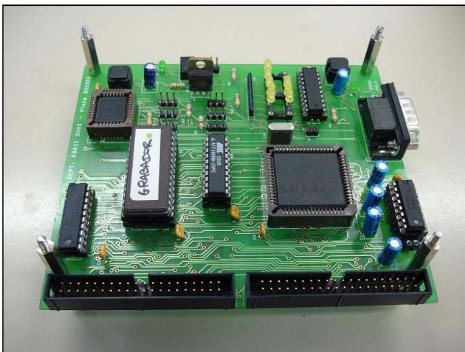
Figura 2-1. Placa de desenvolupament de sistemes microcontrolats
