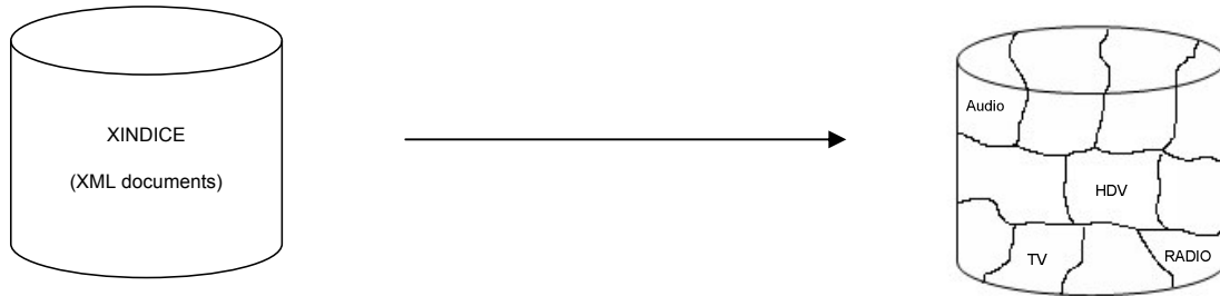
Fig. 3.4 Paso hacia la localización distribuida. Fragmentación de la base de datos para crear nodos especializados.
