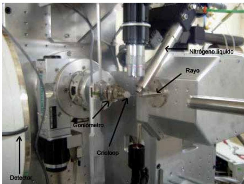
Fig. 3.8. Imagen del difractor de la línea BM16 del Sincrotrón de Grenoble (ESRF).
