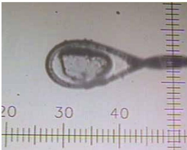
Fig. 3.7. Detalle de un crioloop con un cristal en su interior.
