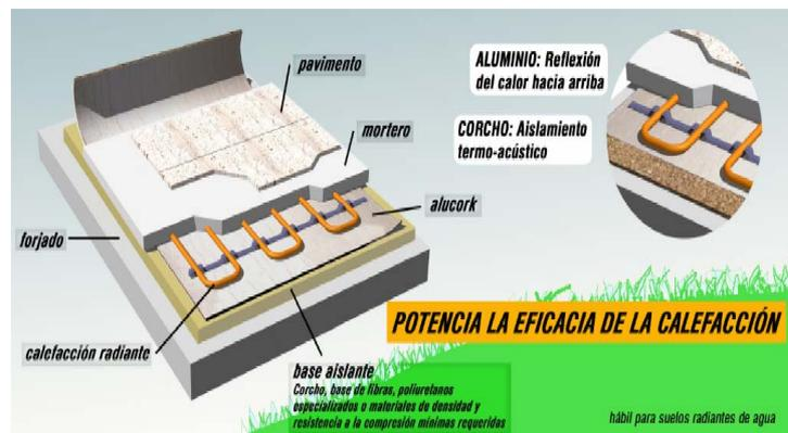
Ilustración 16. Detalle del aislamiento entre forjado de la caseta y la base para el suelo radiante.
