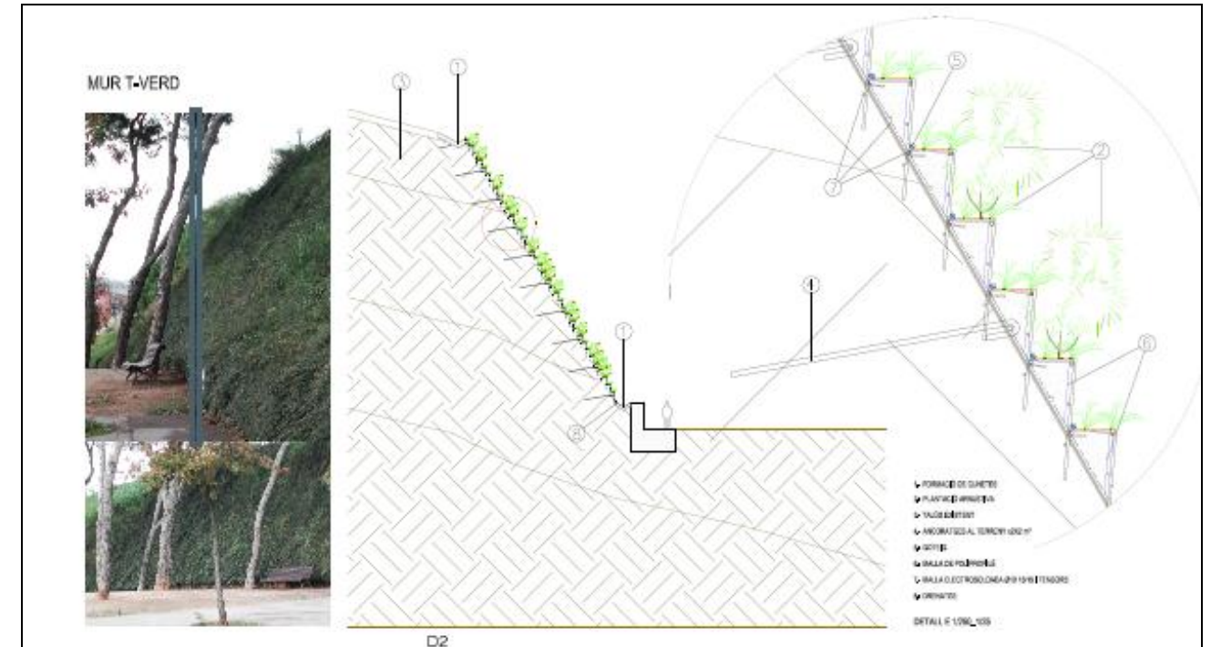
Imatge 2.4: Plànol secció sistema T-Verd.
