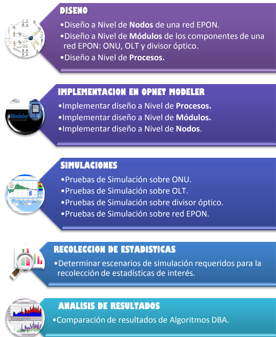
Figura 12: Subfases del modelado de una Red EPON, mediante el simulador OPNET Modeler.
