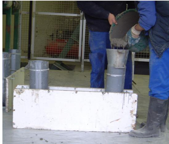
**Figura 26.** Ejemplo de ensayo del tubo en U (Gomes et al.; 2002)
