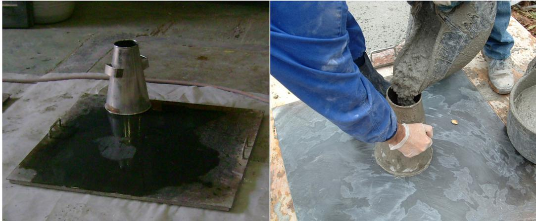
**Figura 28.** Ensayo de escurrimiento.
