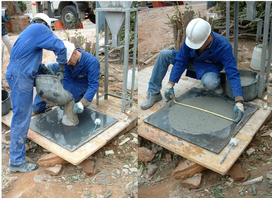
**Figura 76.** Ensayo de escurrimiento realizado a pie de obra.
