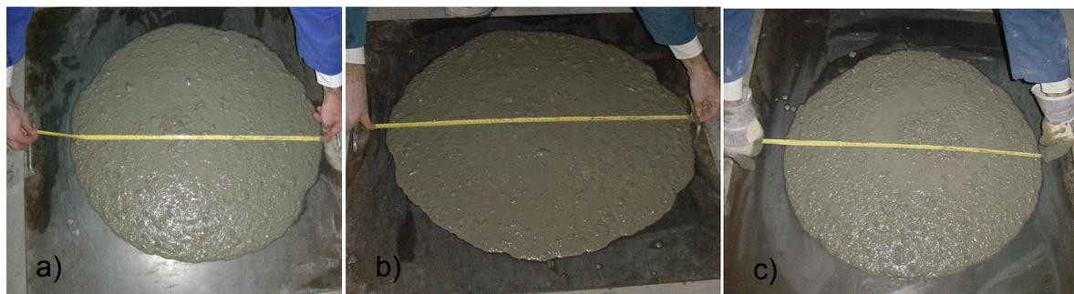
**Figura 43.** Ensayo de escurrimiento.
