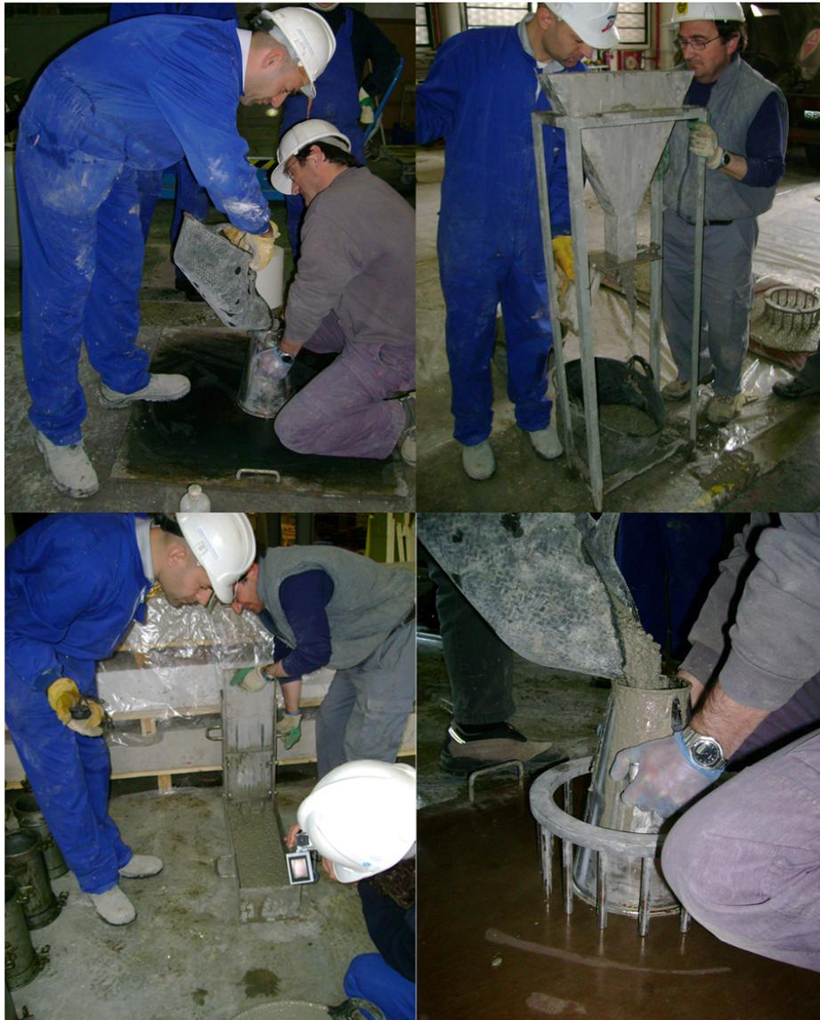
**Figura 25.** Ensayos para la caracterización del HAC.
