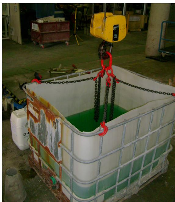
**Figura 63.** Agua con aditivo incorporado preparada para ser incorporada en laboratorio a la cuba del camión hormigonera.
