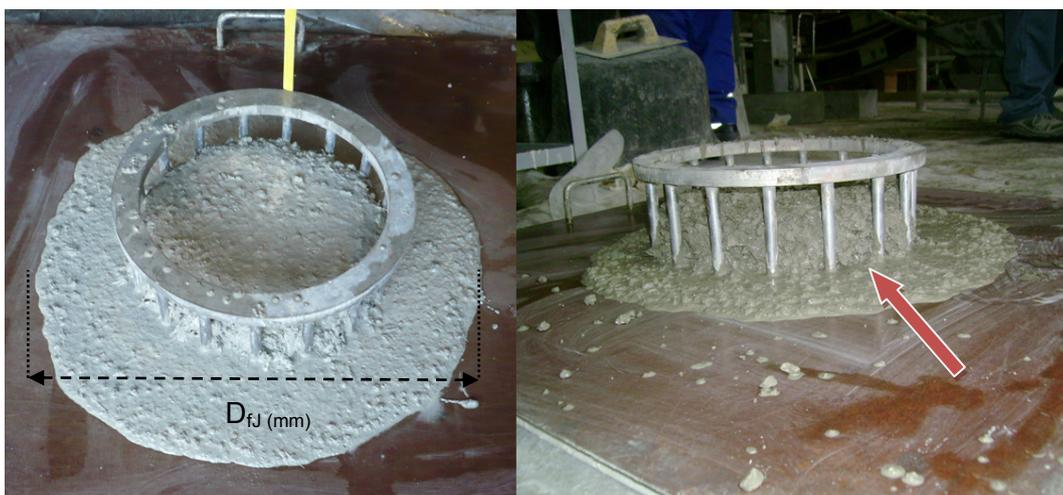
**Figura 33.** Concentración de árido, ensayo anillo J.
