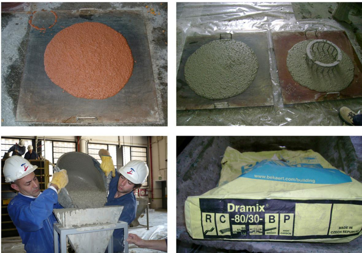
**Figura 64.** Aspecto típico del ensayo de escurrimiento y escurrimiento con anillo J (panel 2), ejecución del ensayo del embudo en V y fibras de acero utilizadas (panel 4)
