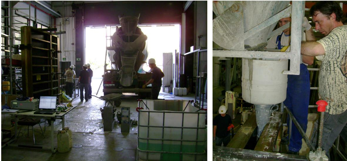
**Figura 65.** Aplicación del HAC en paneles de vivienda, fase experimental.
