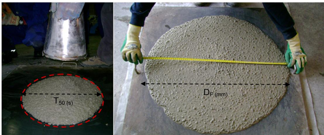
**Figura 29.** Ensayo de escurrimiento
