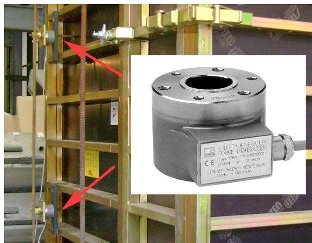
**Figura 66.** Celda de carga utilizada para el ensayo.
