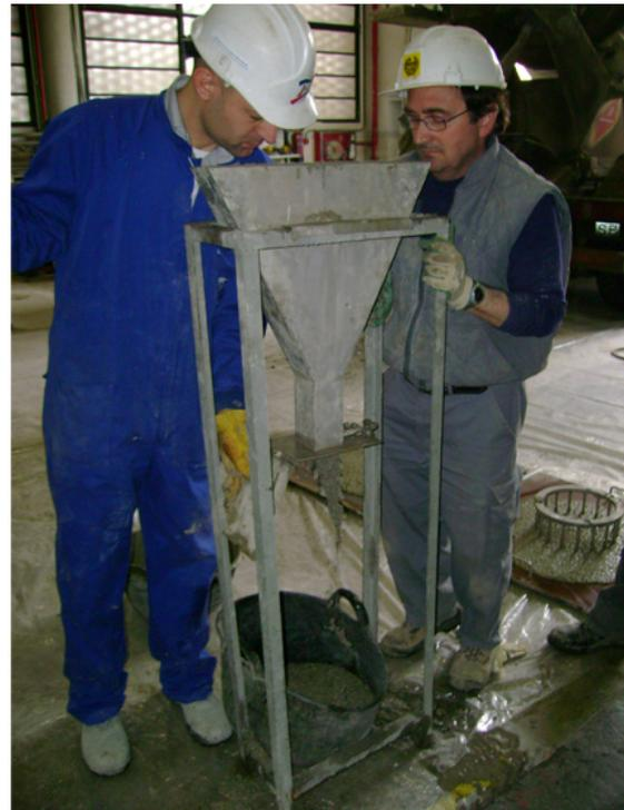
**Figura 30.** Ensayo embudo-V
