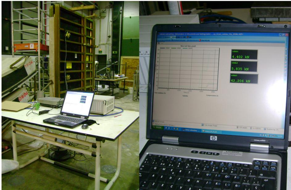
**Figura 67.** Esquema general de los equipos e instrumentos (izq.) y sistema de captación de la presiones (der.)
