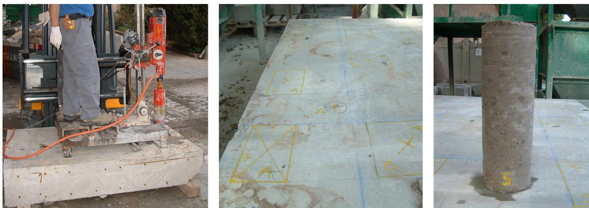
**Figura 83.** Extracción de testigos de los muros cortados.
