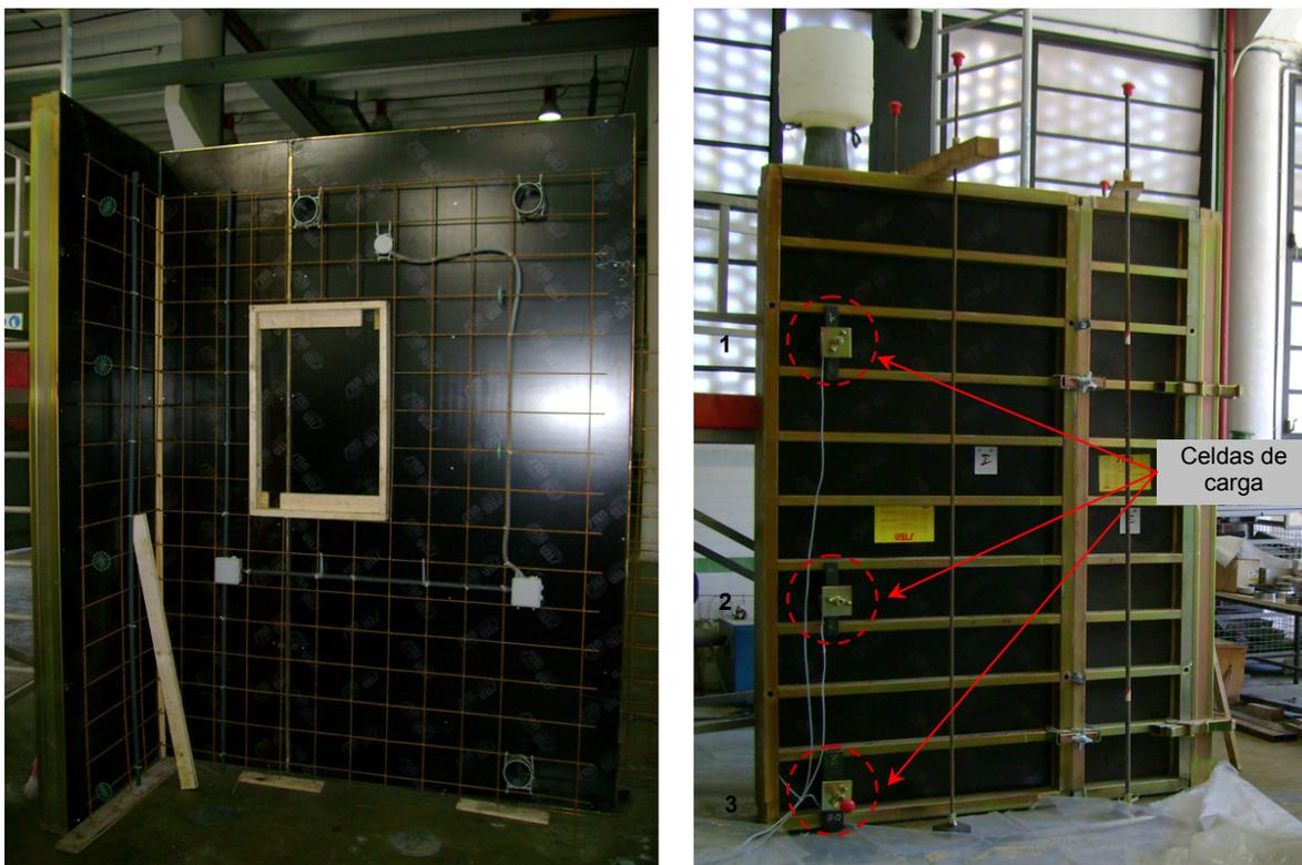
**Figura 61.** Aspecto interior y exterior de los encofrados.
