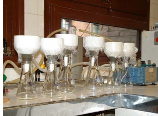
Figura 19. Rampa de filtració.
