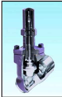
Figura 39. Válvula frigorífica de regulación manual en acero al carbono de “Le Robinet Frigorifique Français”.
