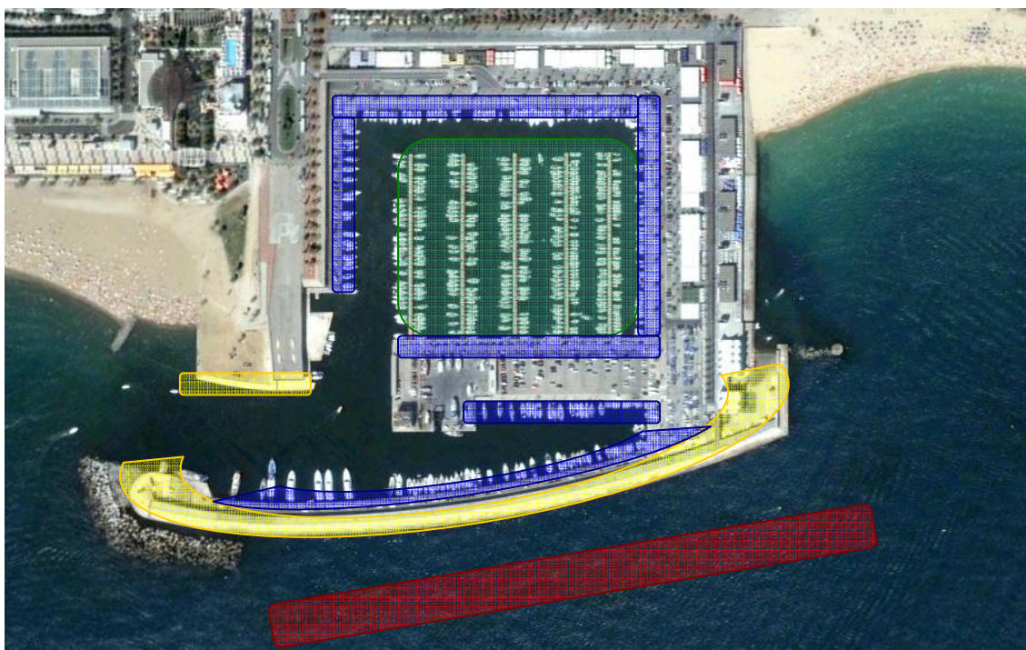
Fig. 1: Planta del port de Olímpic de Barcelona indicant les parts bàsiques d'aquest. En vermell està marcat el dic submergit d'escullera; en groc el dic vertical i contradic; en blau els molls de formigó, alguns amb pantanans flotants; i en verd els pantanans de lloses de formigó pretesat.
