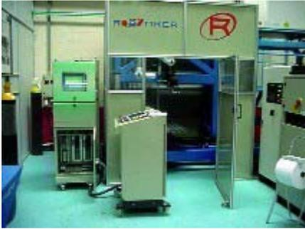
Fig. 6.- Armario de control desarrollado por Robotiker comunicado con célula de corte.
