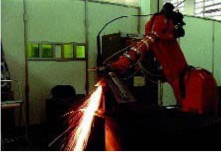
*Fig. 2.- Célula de corte robotizada de Robotiker*
