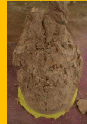
Probeta 04/06/10 (3) Conservación: 10 días en ambiente laboratorio + 99 días en cámara de CO 2 Tensión de rotura: 47,14 kg/cm 2
