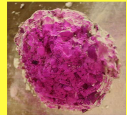
Probeta 17/03/10 (Hormigón VI) Conservación: 180 días ambiente laboratorio Tensión de rotura: 9,05 kg/cm 2
