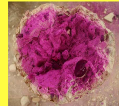
Probeta 07/05/10 (Hormigón IX) Conservación: 140 días ambiente laboratorio Tensión de rotura: 15,96 kg/cm 2
