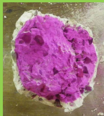
Probeta 31/5/10 (4) Conservación: 113 días ambiente laboratorio Tensión de rotura: 17,66 kg/cm 2
