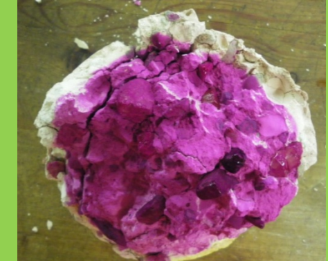
Probeta 31/5/10 (1) Conservación: 113 días ambiente laboratorio Tensión de rotura: 13,92 kg/cm 2
