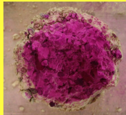
Probeta 03/03/10 (Hormigón III) Conservación: 200 días ambiente laboratorio Tensión de rotura: 8,88 kg/cm 2
