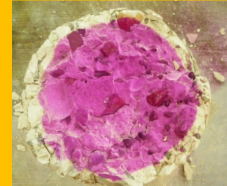
Probeta 01/06/10 (4) Conservación: 112 días en ambiente de laboratorio Tensión de rotura: 16,01 kg/cm 2
