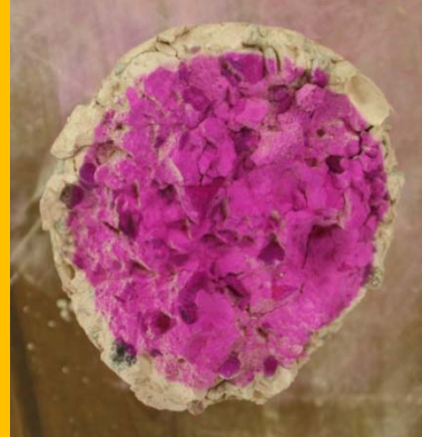
Probeta 01/06/10 (7) Conservación: 112 días en ambiente de laboratorio Tensión de rotura: 17,15 kg/cm 2
