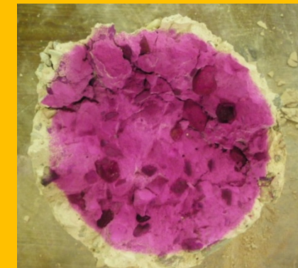
Probeta 01/06/10 (6) Conservación: 112 días en ambiente de laboratorio Tensión de rotura: 18,45 kg/cm 2
