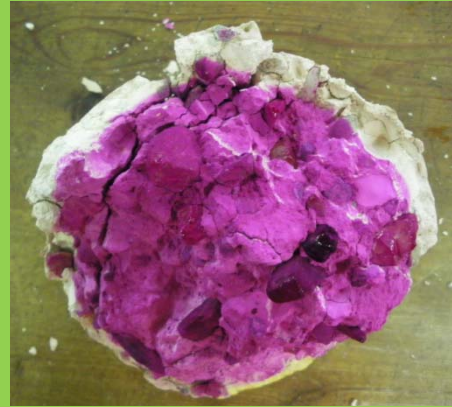
Probeta 31/5/10 (2) Conservación: 113 días ambiente laboratorio Tensión de rotura: 19,01 kg/cm 2
