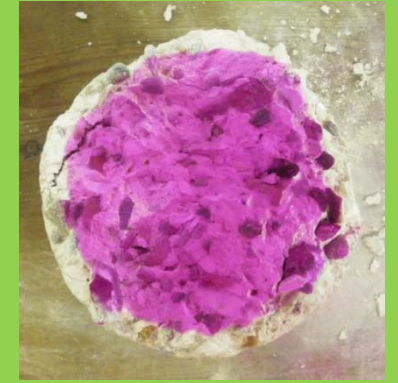
Probeta 31/5/10 (3) Conservación: 113 días ambiente laboratorio Tensión de rotura: 19,13 kg/cm 2
