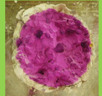
Probeta 31/5/10 (5) Conservación: 113 días ambiente laboratorio Tensión de rotura: 17,60 kg/cm 2
