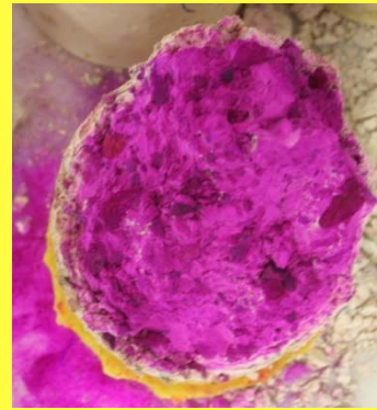
Probeta 17/03/10 (Hormigón V) Conservación: 120 días ambiente laboratorio Tensión de rotura: 11,09 kg/cm 2
