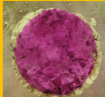
Probeta 01/06/10 (5) Conservación: 112 días en ambiente de laboratorio Tensión de rotura: 17,03 kg/cm 2
