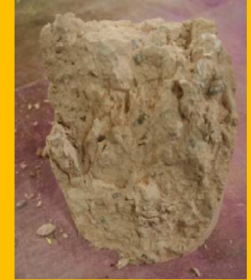
Probeta 04/06/10 (1) Conservación: 10 días en ambiente laboratorio + 99 días en cámara de CO 2 Tensión de rotura: 52,01 kg/cm 2
