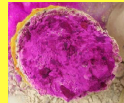
Probeta 03/03/10 (Hormigón IV) Conservación: 140 días ambiente laboratorio Tensión de rotura: 13,13 kg/cm 2
