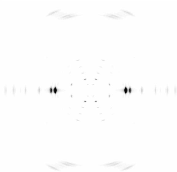
Figura 9.14: Diagrama de rayos X simulado para el PE(8,10) suponiendo un grupo espacial  $P12_1/a1$
