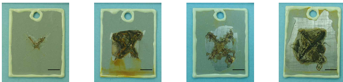
Fig. D.7. Fotos digitales de las probetas de pintura con 1,0% en peso de PC3 después de la evaluación de adherencia: 120 horas (a), 240 horas (b), 480 horas (c) y 720 horas (d). Escala: 9 mm.
