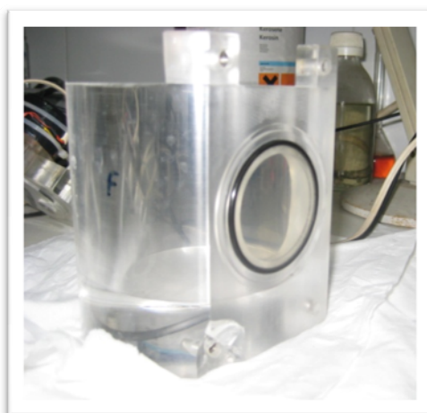
Figura 5.42. Soporte de un sistema de membranas
