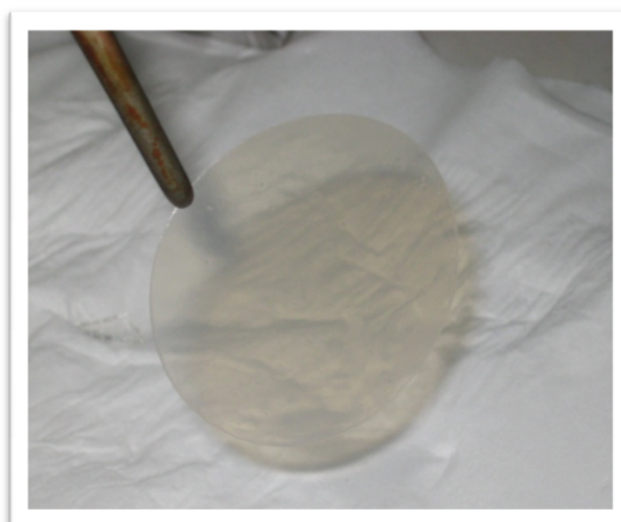
Figura 5.40. Membrana líquida soportada impregnada en extractante
