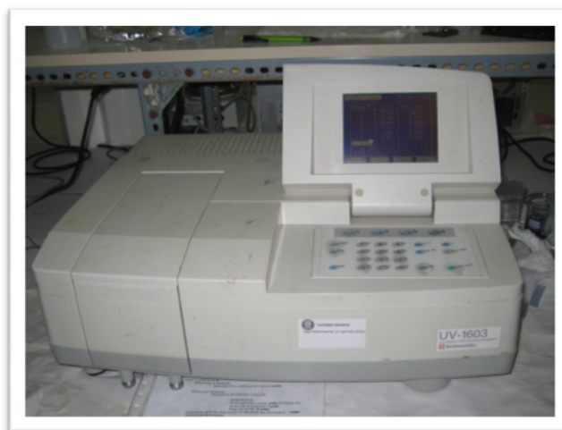
Figura 5.2. Espectrofotómetro de absorción molecular
