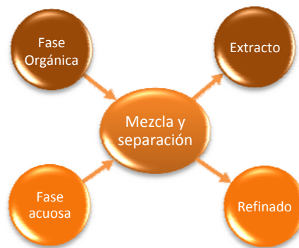
Figura 3.1. Esquema de transferencia de masa de dos fases
