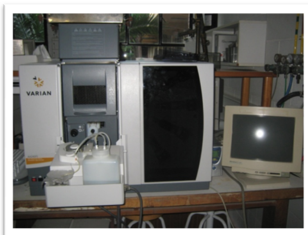
Figura 5.1. Espectrofotómetro de absorción atómica
