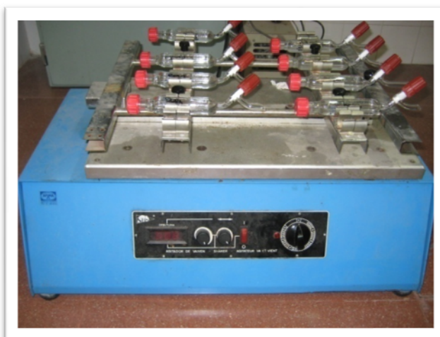
Figura 5.9. Agitador mecánico de vaivén
