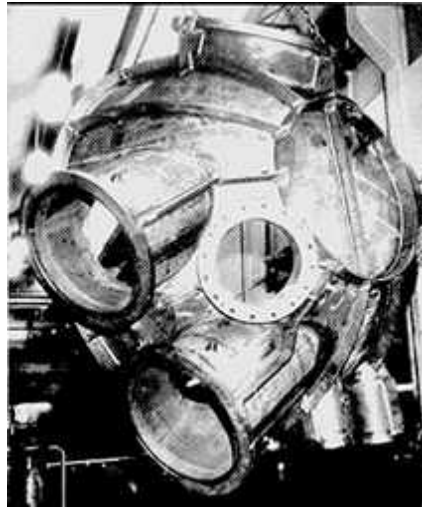
Figura B.2. Caja de agua fabricada en aleación Cu-Ni 90-10
