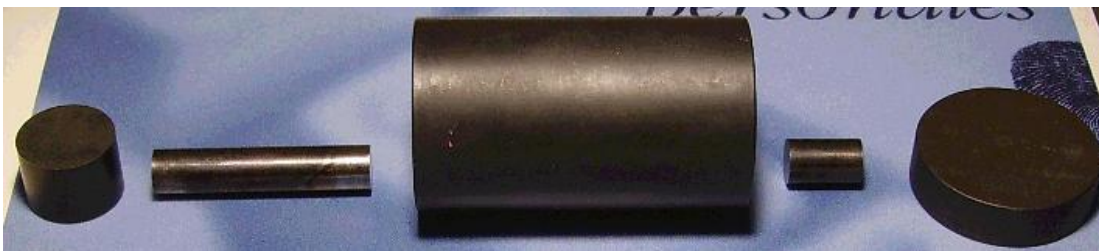
Figura 4.3-1 Fotografía del molde y elementos relacionados de diámetro 9,2mm. Se puede observar: los dos apoyos utilizados para no marcar las mordazas en los extremos, en el centro la matriz, a la derecha de esta la contraparte y a su izquierda el punzón.
