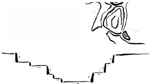
Sección original del terreno en "Clot de l'infern" construido con muros de piedra seca para generar campos de cultivo. Actualmente se utiliza para conciertos al aire libre como si de un teatro griego se tratara.
