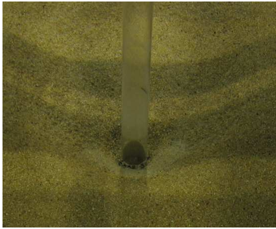
Foto 1. Foso de erosión pila 4.
