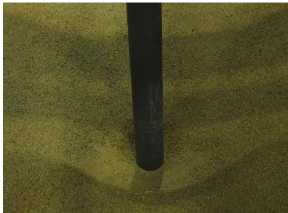
Foto2. Foso de erosión pila 5.
