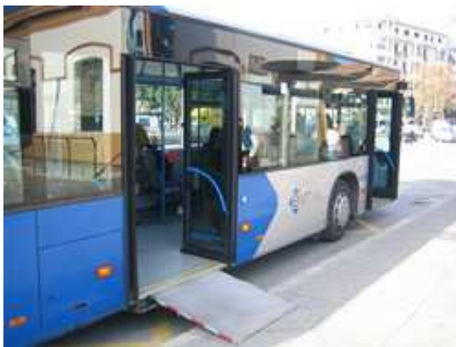
Figura 2. Autobús dotat de rampa d'accés per persones de mobilitat reduïda
