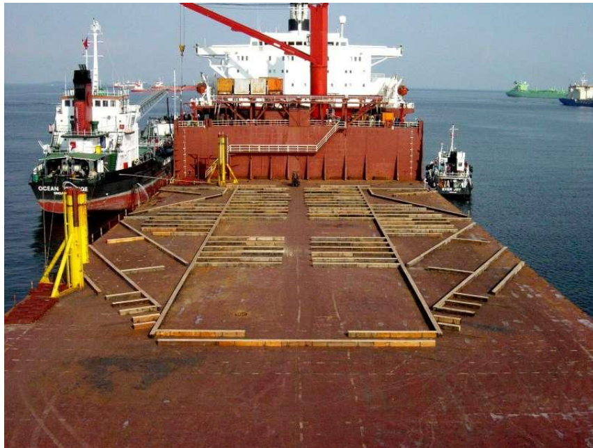
Imagen n° 33: Entibacion en madera
