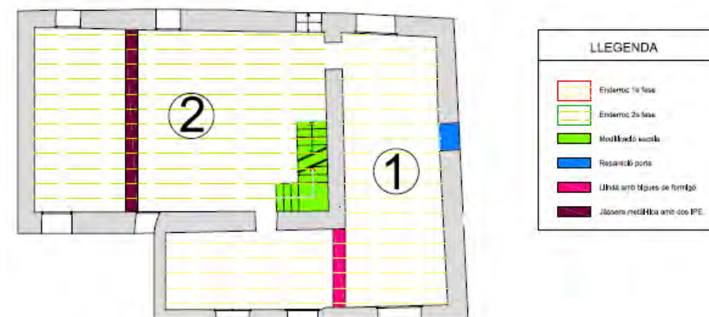
5/9. S'observa en ombrejat groc la part enderrocada
