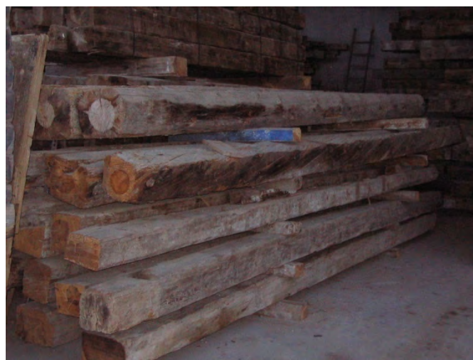
13.2.3.3/1. Imatge feta per l'autor del projecte d'un aplec de bigues de fusta en una serradora de la zona, bigues de fusta de pi i llargada 6 m. (tenen característiques semblants a les antigues).
