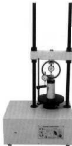
Figura 6.6. Equipo ensayo compresión simple
