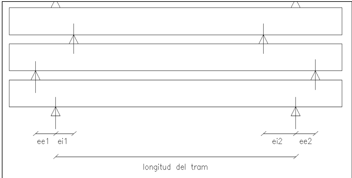
Fig. 4.6 Esquema de càrrega de la segona dovella
