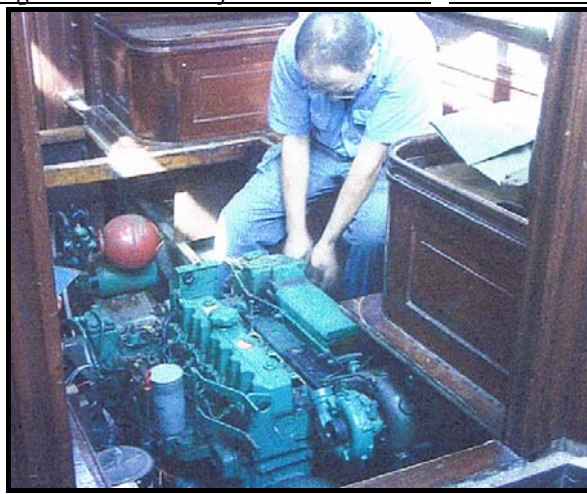
Figura 10: Inicio de levantamiento del motor principal. Fuente: autor
