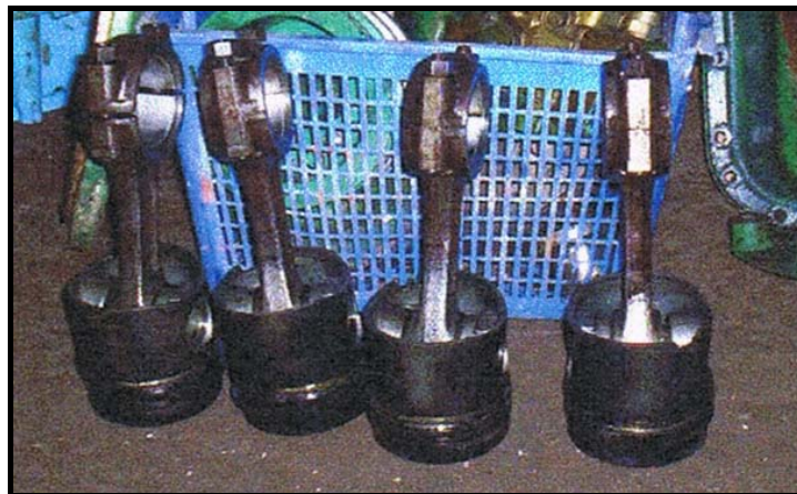
Figura 26: Los cuatro pistones del motor. Fuente: autor
