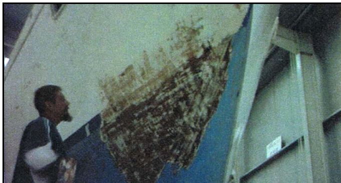
Figura 43: Decapado del casco. Fuente: autor
