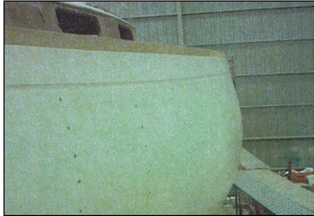
Figura 100: Casco imprimado para correcta unión de materiales. Fuente: autor
