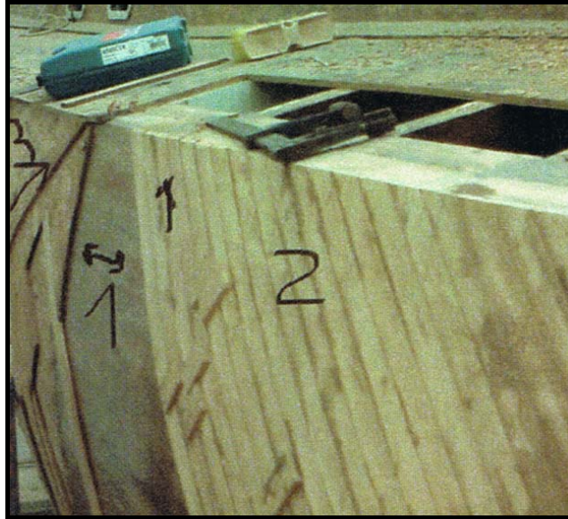
Figura 64: Laminado del casco. Fuente: autor
