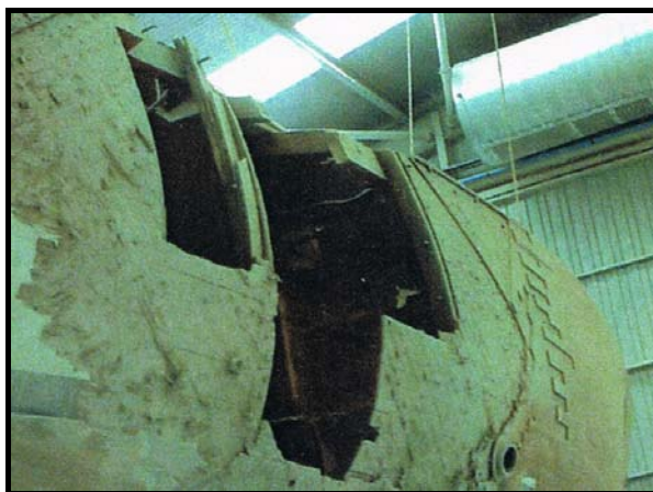
Figura 50: Desguazado de la obra muerta. Fuente: autor
