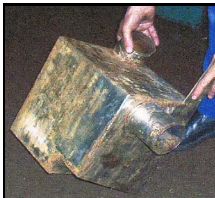
Figura 27: Colector de escape. Fuente: autor
