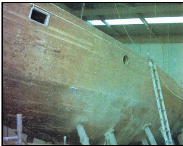
Figura 54: Pelado integral del casco. Fuente: autor
