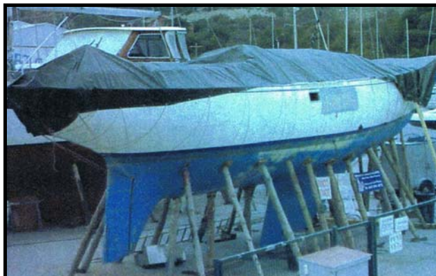
Figura 41: Barco apuntalado. Fuente: autor
