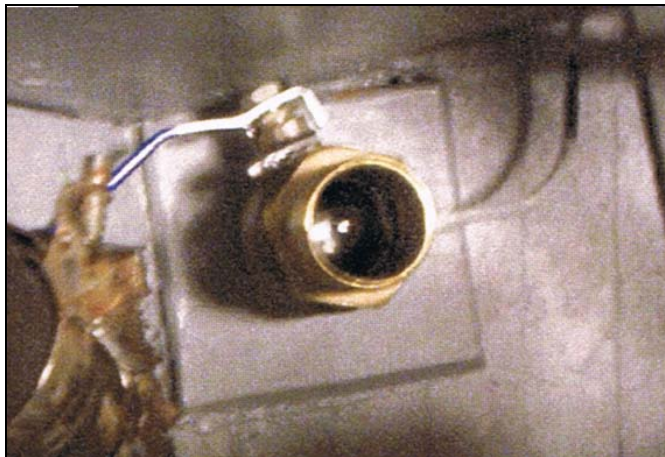
Figura 104: Pasa casco y pintura de dos componentes para la sentina. Fuente: autor
