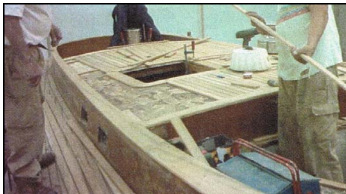
Figura 88: Forrando de teca el alzado de popa. Fuente: autor
