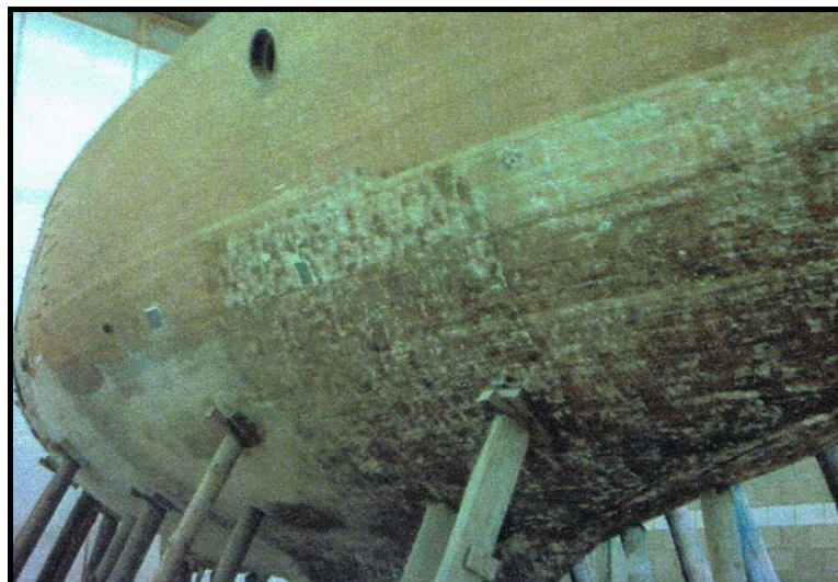
Figura 53: Pelado integral del casco. Fuente: autor
