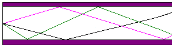
Fig. 2.1 Propagación en una fibra multimodo.
