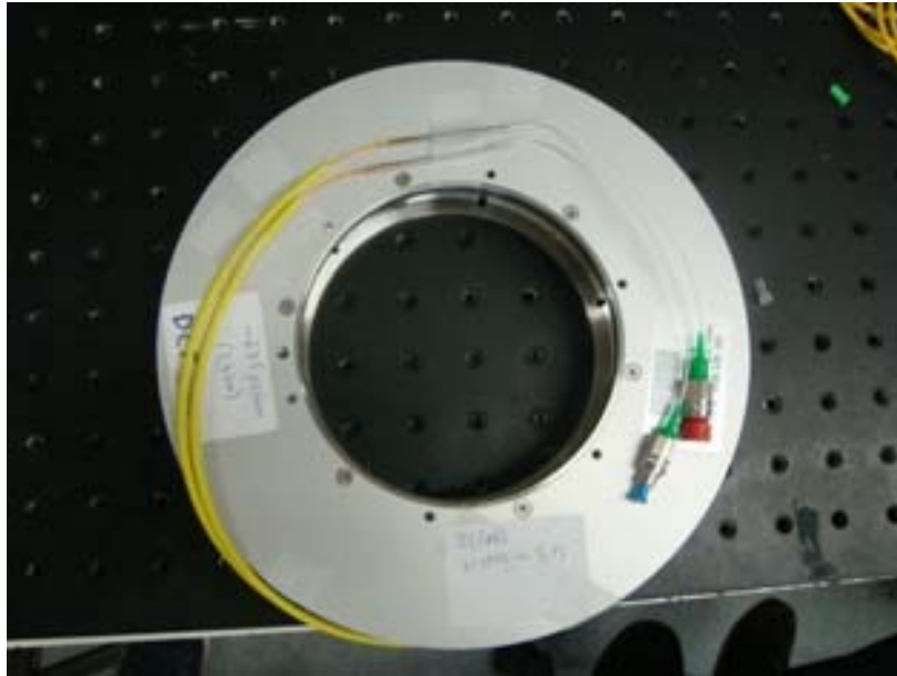
Fig. 3.23 Fibra compensadora de dispersión cromática
