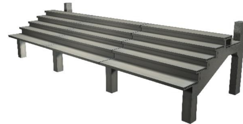
fig.3.2.6.B1 –Ejemplo tipo de gradas prefabricadas.
