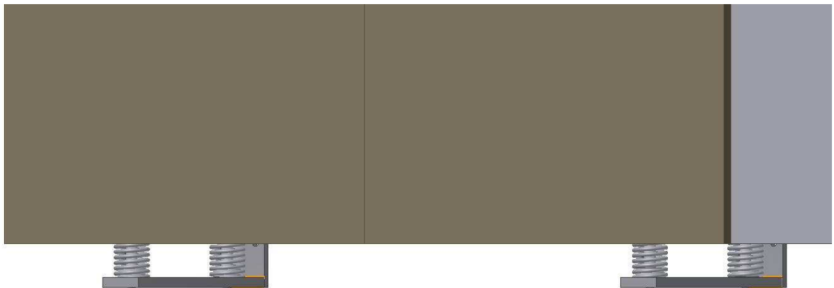
Figura 5.2.2 Vista inferior del armario con el sistema de pesaje al completo.
