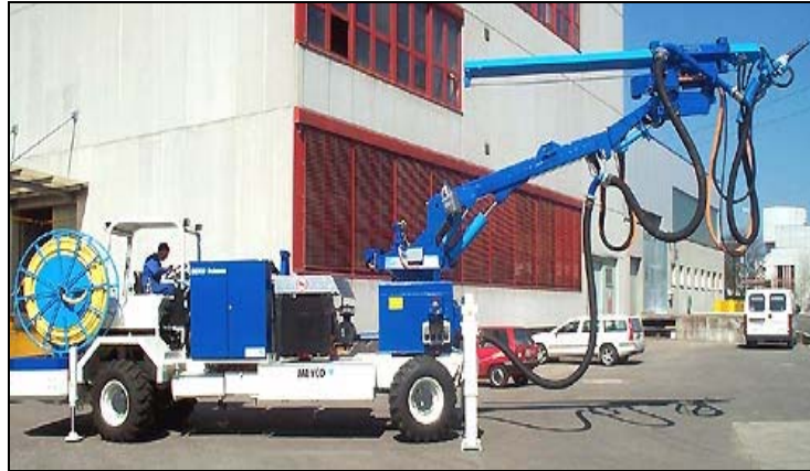
Figura. 2.3.-Robot de proyección automático de última generación.
