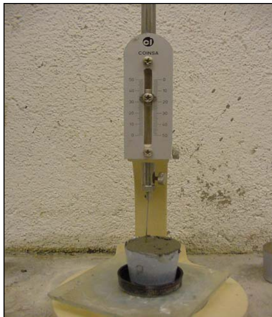
Figura 3.1 – Vicat Manual para medidas de inicio y final de fraguado en pastas
