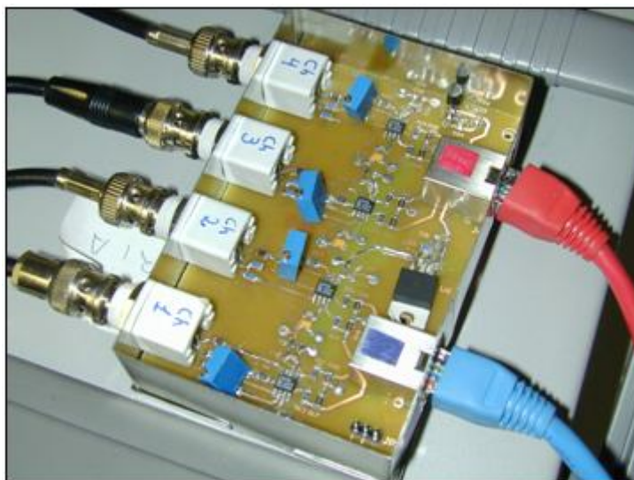
Figura 5-23: Placa de adaptación que permite inyectar señal sintética a cada uno de los cuatro canales por separado y llevarla al ADC.
