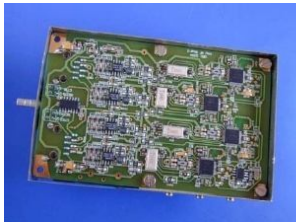
Figura 3-8: Fotografía de la etapa de FI del receptor de PAU-RAD [3].
