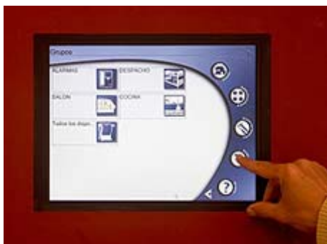
Fig. 3.3. Pantalla Táctil TFT encastada a la pared (15”).
