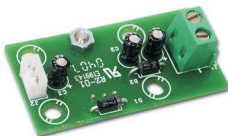
Fig. 13.4. Regulador de tensión.
