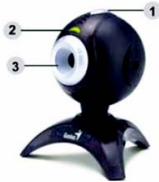
Fig. 3.11 La webcam VideoCAM GE111. 1. Botó de fotografia / 2. LED / 3. Objectiu
