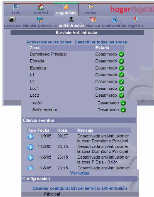
Fig.49: Pantalla de control de zonas de seguridad.
