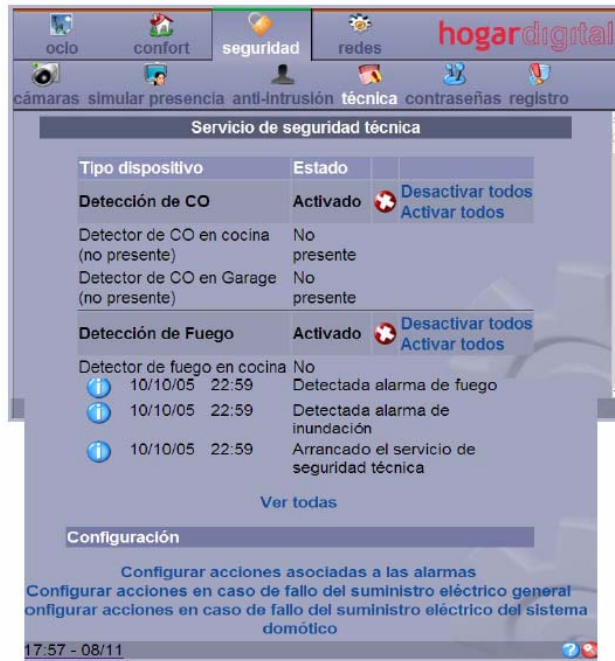
Fig.50: Pantalla de control de seguridades técnicas.
