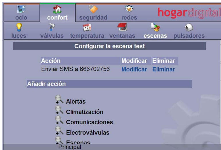
Fig.47: Menú de macros que se activan por eventos o por acción manual.
