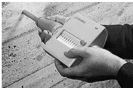
Figure 3.8: Photo d'un marteau de Schmidt. [18]
