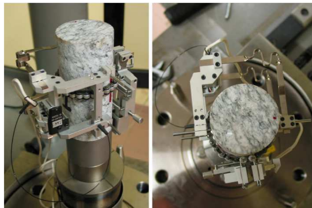
Figure 1.17 : Capteurs de déplacement longitudinal et circonférentiel montés sur l'éprouvette. [17]
