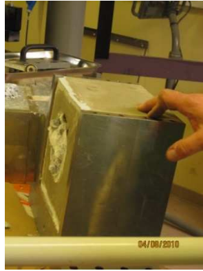
7. Éponte supérieure après l'essai
