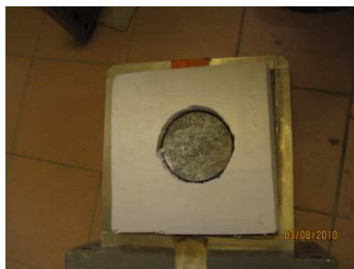
4. Demi-boite avec l'échantillon inférieur et le coulis sans les pinces
