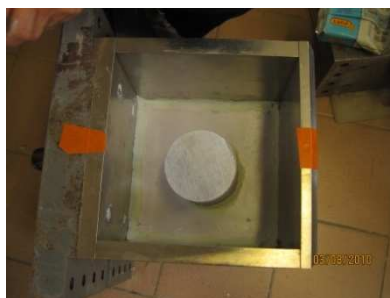
8. La demi-boite supérieure avec l'échantillon et le coulis sec
