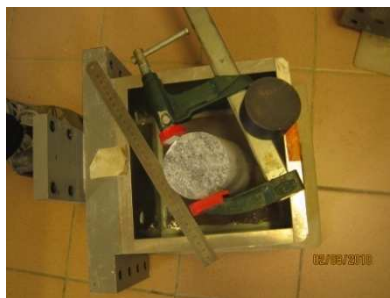
2. Demi boîte inférieure avec l'échantillon positionat
