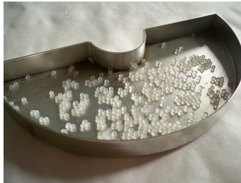
Figura 40: Bandeja del liofilizador con perlas de alginato de calcio
