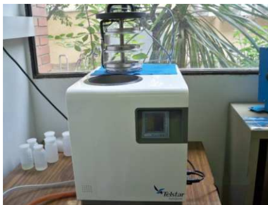
Figura 42: Liofilizador utilizado en la liofilización de las perlas de alginato de calcio
