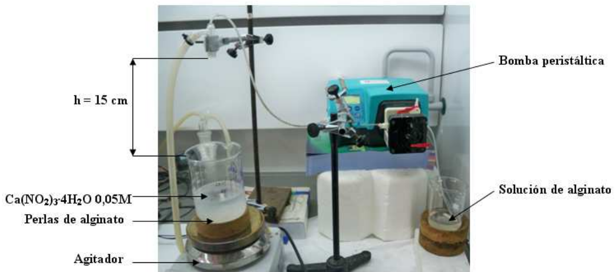
Figura 37: Fabricación y montaje de las perlas de alginato de calcio
