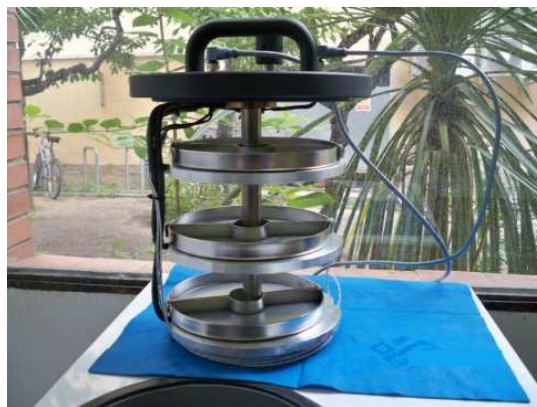
Figura 41: Compartimento de bandejas del liofilizador
