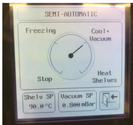
Figura 43: Pantalla del liofilizador indicando el punto del proceso (vacío)
