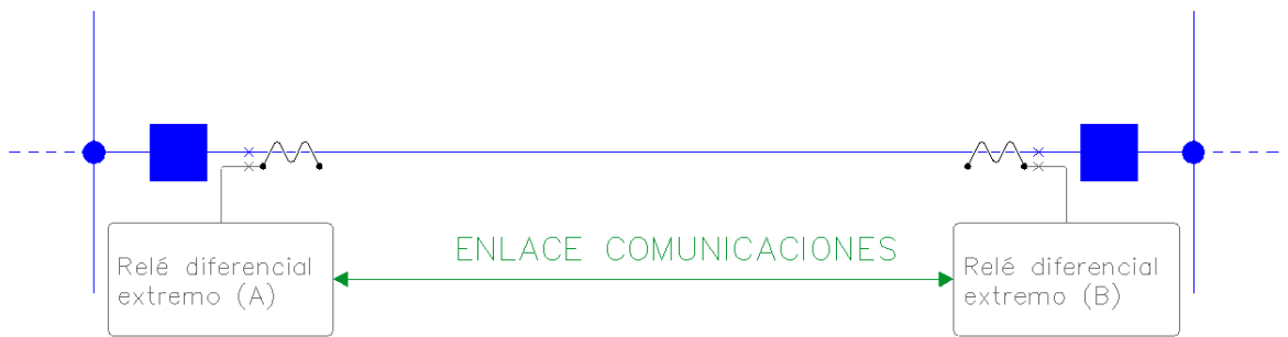
Fig 4.8 Protección diferencial circuito AT, extracción del curso formación CPG SSEEP URL-La Salle
