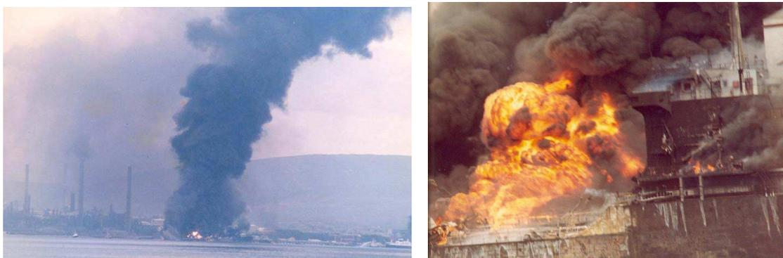
Fig. 8.12. y 8.13. Algeciras (España), 1985. Explosión del buque panameño Petrogen One, tras la rotura de uno de sus tanques con nafta por un problema de exhaustación de gases.
