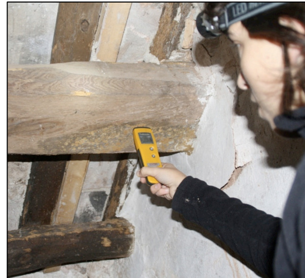
Foto 17: Utilització de el higròmetre d'agulles
