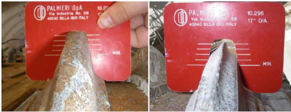
Figura 7.5 Desgaste de un disco simple de Palmieri.
