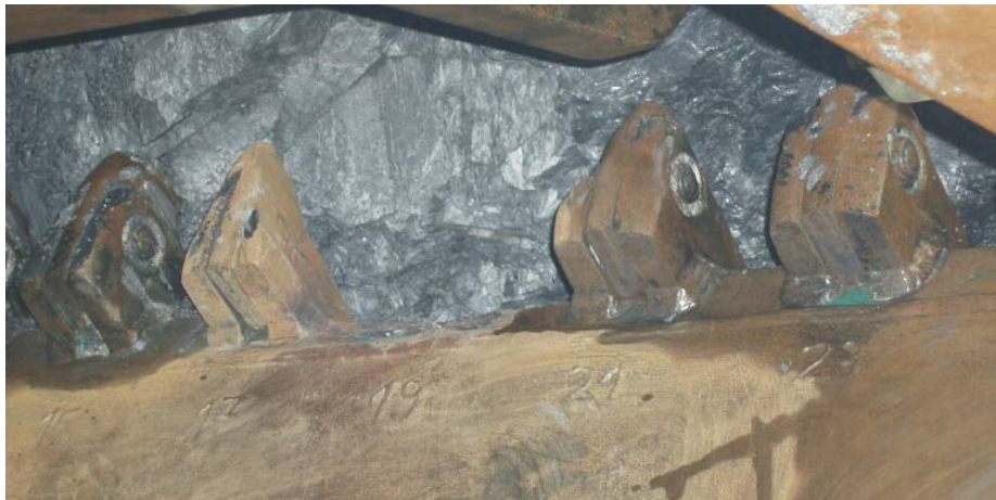
Figura 7.12 Desgastes en portapicas. Portapicas posiciones 15,17 y 21 desgastados, posición 19 ha desaparecido.
