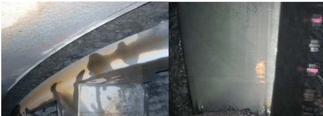
Figura 7.19 Desgastes reales producido en el perímetro exterior de una cabeza de corte.
