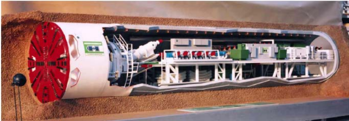
Figura 2.8. Maqueta de un escudo tipo EPB de frente cerrado (Cortesía Herrenknecht AG)
