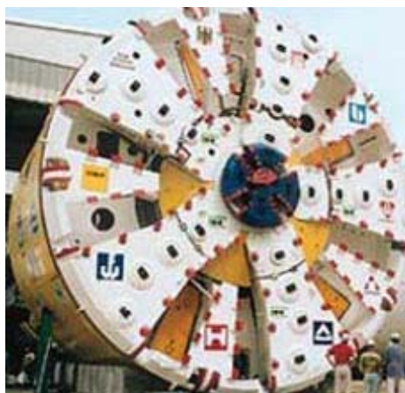
Figura 2.7 Fotografía de un escudo presurizado (Trenchless Technology)
