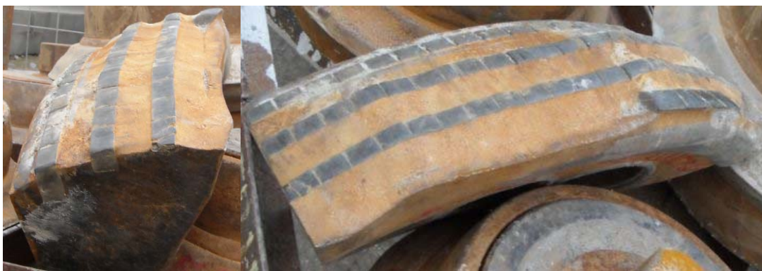
Figura 7.15 Detalle de desgaste de un rastrel, vista frontal y en planta.
