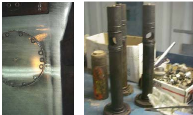
Figura 7.17 Detalle del registro y forma de una lanza de espuma.
