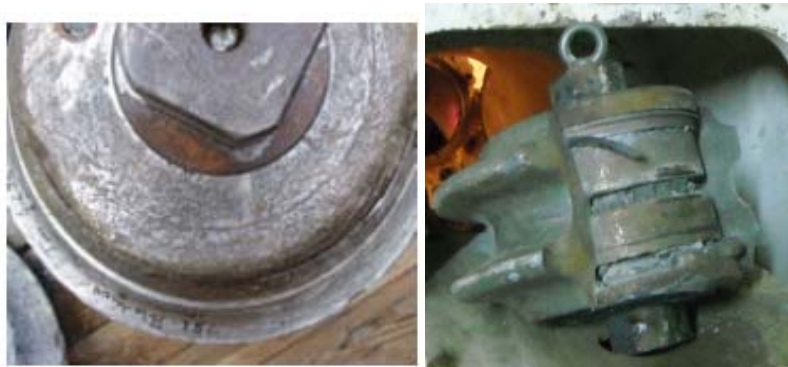
Figura 7.9 Detalles de rotura por carcasa de los rodillos defectuosa.
