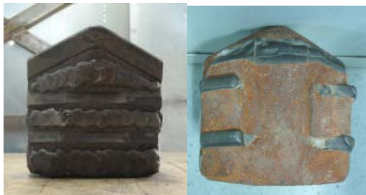
Figura 7.10 Vista frontal del desgaste de una pica.
