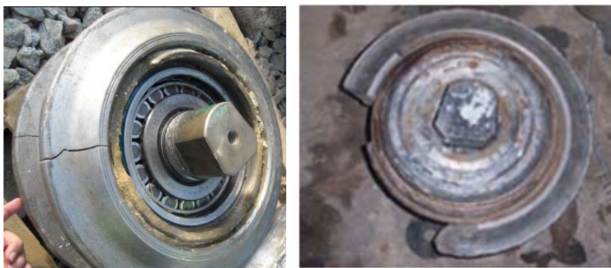
Figura 7.6 Fisura y rotura de un anillo de corte por presión aplicada muy fuerte.
