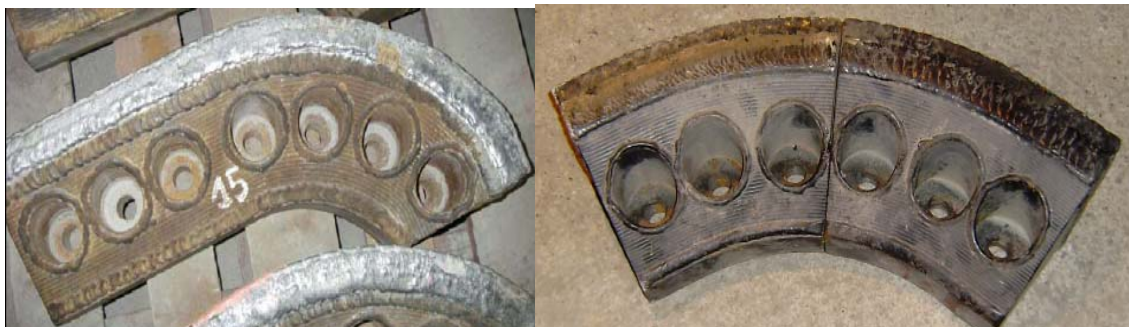
Figura 7.5 Vista de dos tipologías de rastreles. Composición de una sola pieza lado izquierdo y configuración en dos piezas lado derecho.
