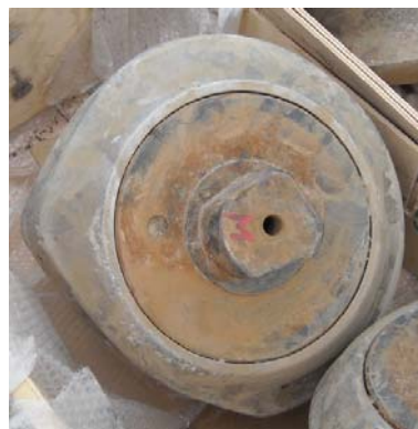
Figura 7.5 Desgaste por alojamiento bloqueado.
