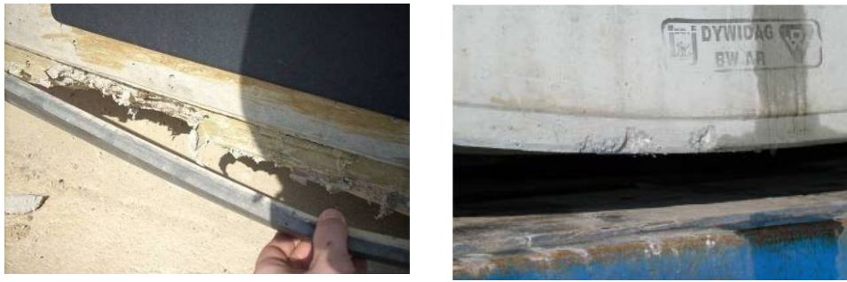
Figura 4.4 Daños causados por una mala manipulación durante el transporte.
