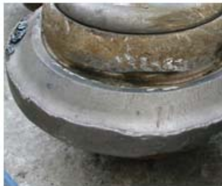
Figura 7.8 Detalle de deformación por “mushrooming”.
