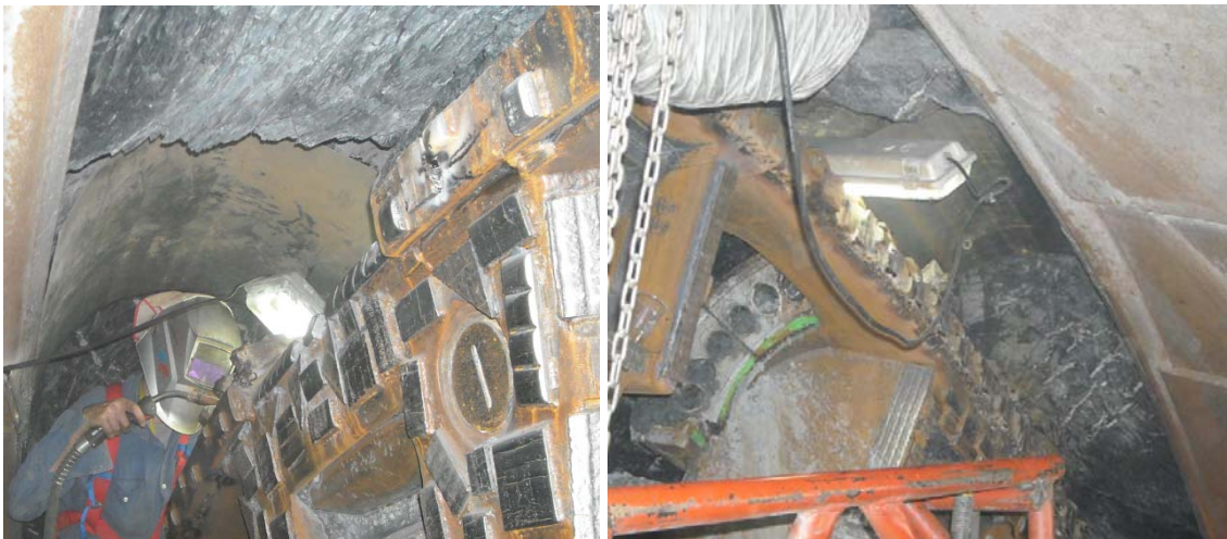
Figura 7.29 Detalle de realces ejecutados siguiendo el esquema anterior.
