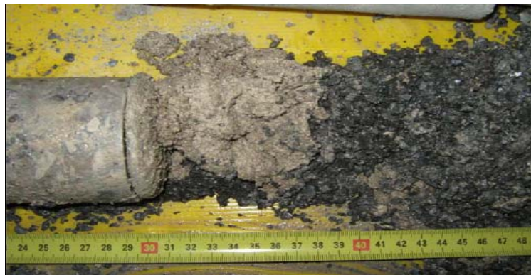
Figura 4.26 Esquema y testigo de mortero. Relleno del gap incorrecto.
