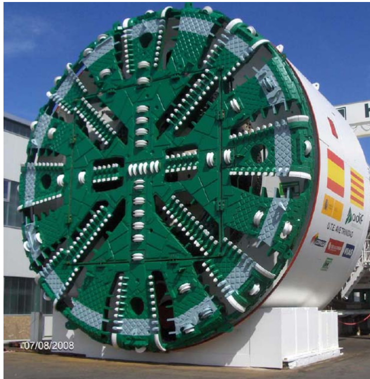
Figura 7.1 Cabeza de corte de la tuneladora “MONTCADA” (2009-2010).
