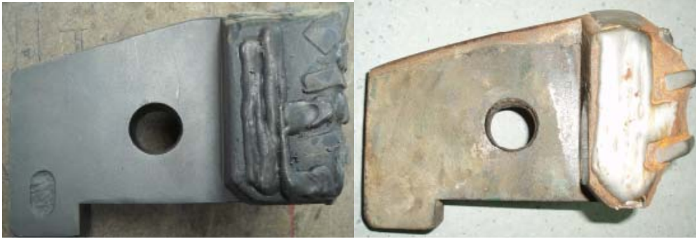
Figura 7.11 Vista lateral del desgaste de una pica.
