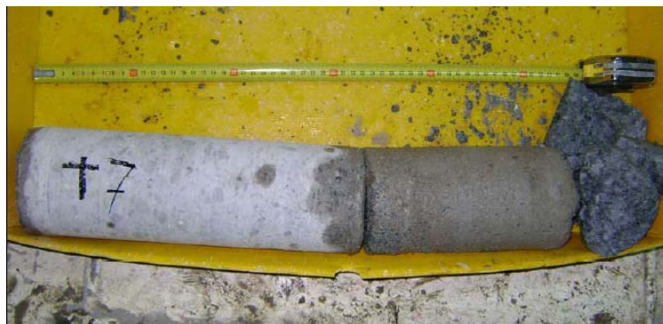
Figura 4.25 Esquema y testigo de mortero. Relleno del gap correcto.
