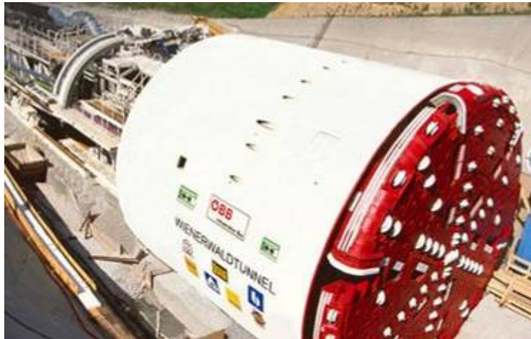
Figura 2.4 Fotografía TBM para roca. Tipo escudada. (Wienerwald, Austria)
